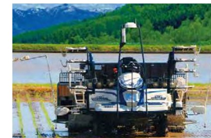
リモコン操作で無人作業ができるGNSS搭載ロボット田植機
