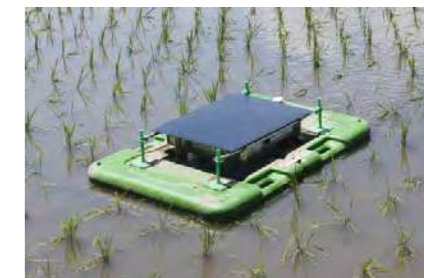
自動抑草ロボット「アイガモロボ」
