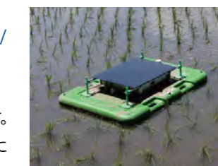
自動除草ロボット「アイガモロボ」
