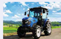
シートベルトの装着を促すシートベルトリマインダー、オペレーターの離席を検知してPTOを停止する探知機能等の安全を装備したトラクタBFシリーズ
