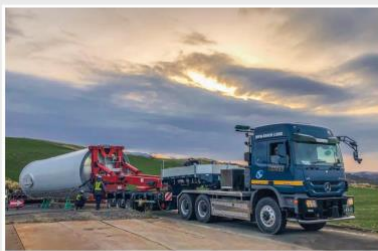
プライムムーバー（風車タワー輸送）
