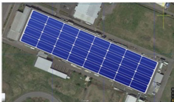
茅野工場 太陽光発電装置の設置レイアウト
